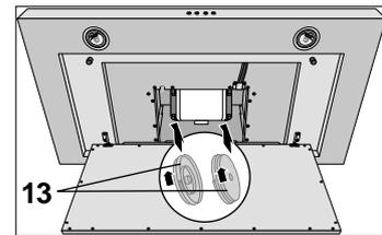
5. Fettfilter **12** mit dem hinteren Ende in die Aussparung unten an der Dunstabzugshaube setzen. Die Verriegelung **11** nach hinten schieben, den Fettfilter **12** nach oben hin zuklappen und die Verriegelung wieder loslassen.
