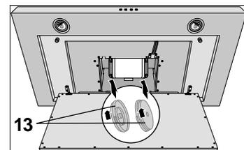
4. Fettfilter **12** mit dem hinteren Ende in die Aussparung unten an der Dunstabzugshaube setzen. Die Verriegelung **11** nach hinten schieben, den Fettfilter **12** nach oben hin zuklappen und die Verriegelung wieder loslassen.
