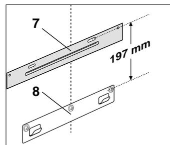
6. Zwei Dübel in die Bohrlöcher stecken.
