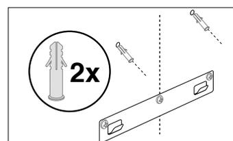
7. Zwei Bohrlöcher für die Wandhalterung **6** des oberen Teils **2** der Kaminblende anzeichnen.
