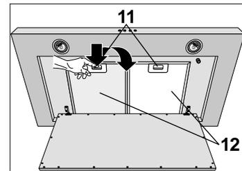
5. Sind die Fettfilter vollständig getrocknet, Fettfilter hinten in die Aussparung einsetzen.
