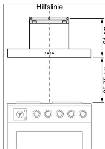
3. An diesen Punkt das mittlere Loch der Wandhalterung **8** anlegen, Ausrichtung mit einer Wasserwaage prüfen und die drei Bohrlöcher markieren.
