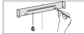
8. An den markierten Stellen Löcher mit einem den Dübeln entsprechenden Durchmesser in die Wand bohren.
